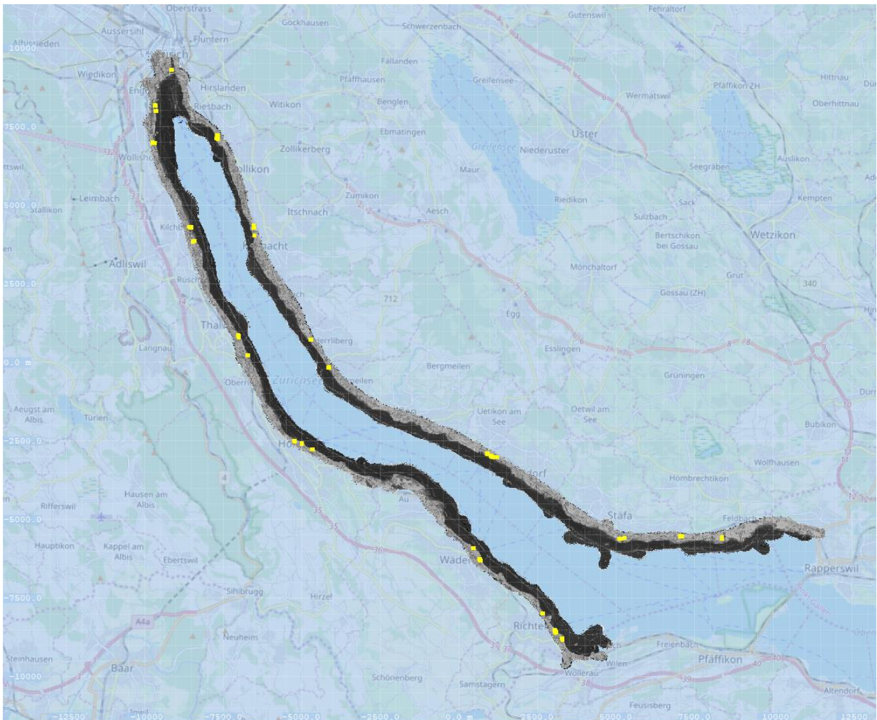
Abbildung 2 Übersicht zur topo-bathymetrischen Befliegung der Uferlinie am Zürichsee im Kanton Zürich im März 2020. Die Lokationen der Passpunktevermessung sind gelb markiert.
