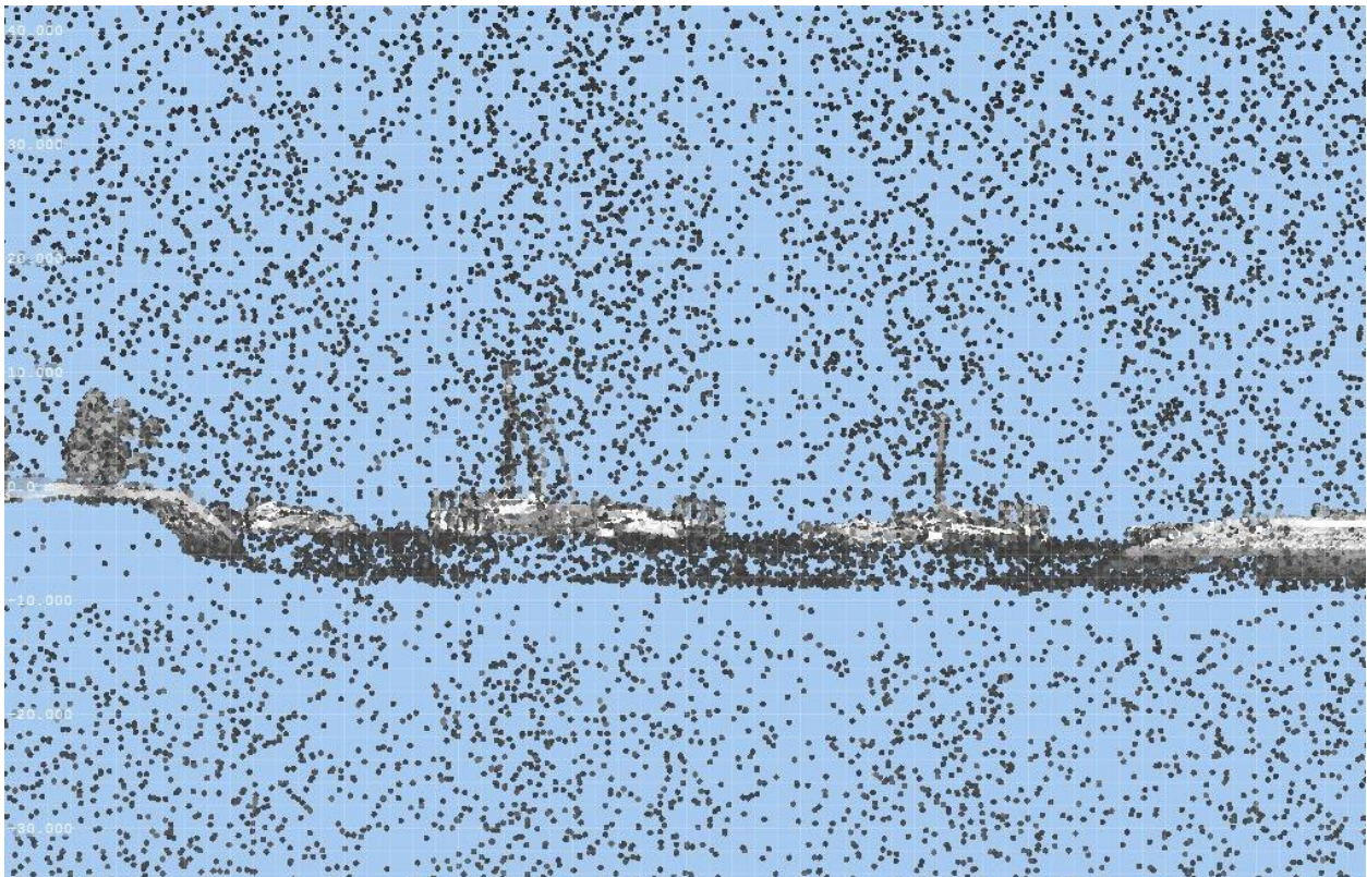
Abbildung 10 Querschnitt durch eine Punktwolke im Bereich einer Hafenanlage: Visuell können Fehlechos und echte Daten klar voneinander getrennt werden.
